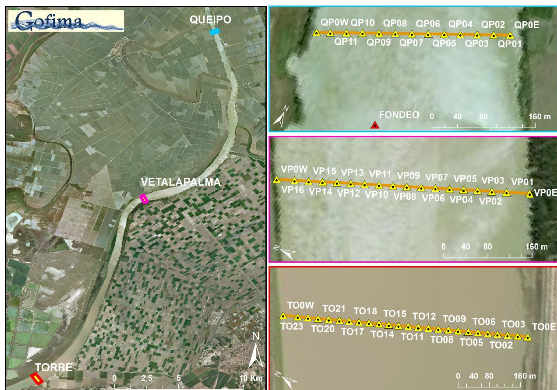
Figura A2-1 – Plan de campaña, con la ubicación de las secciones y distribución de las estaciones previstas. Las etiquetas indican un código identificativo de la sección y el ordinal de las estaciones CTD, numeradas de este a oeste. Los fondeos de las orillas se identifican con el número 0 y una letra indicativa de la orilla este (E) ó oeste (W). El fondeo de Queipo es representado con un triángulo rojo.
