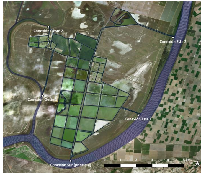
Figura 5.1 –Ortofoto Guadalquivir_z16 mostrando la zona de la finca Veta la Palma y las conexiones con el estuario y con el Brazo de la Torre que pueden inferirse tanto de la imagen como de otras fuentes (Acuicultura sostenible en Veta La Palma, Doñana, https://www.youtube.com/watch?v=2U40dA6qb-A ). Se han incluido los bordes de las balsas.
